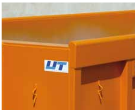
Oberes Längsprofil als gerolltes Tunnelprofil ist optimal gegen Beulen und Bauchen (HEAVY 5 mm S355MC und MEDIUM / LIGHT 4 mm S235JR)
